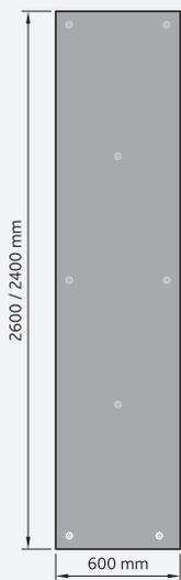
Befestigungspunkte bei punktwiser Verklebung mit Mörtelbatzen und Metalldübeln.
